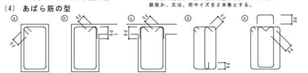
(イ) 原則として(ロ)のフック先曲げとする。片側床版付 (L型) 梁で(ロ)の場合、両側床版付 (T型) 梁で(ロ)又は(イ)とすることができる。
